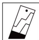
без разбавления 20 сек. при 20°C (нанесение в 1,5 или 2 слоя)
